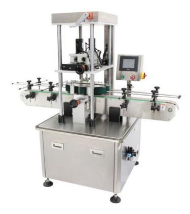
高速星盤鎖蓋機 CR-450S,可確實定位與鎖蓋,普遍適用於化妝品、藥品、食品飲料及各種塑膠蓋之旋緊。自動化鎖蓋可使鎖蓋工作更為輕鬆,並以PLC人機控制系統輔助 您輕易操作,適合中大型生產量的工廠使用。
